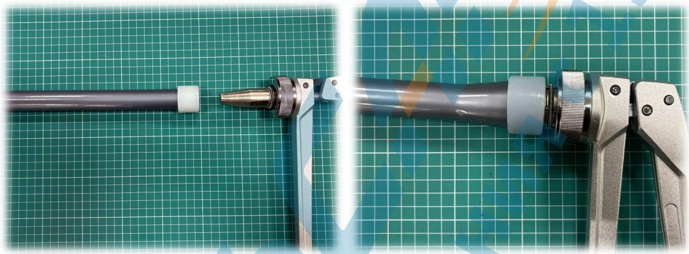
4. После фазы расширения в течение 4-5 секунд в трубу должен быть установлен фитинг до упора. В течение минуты труба полностью сожмется, создав радиальные усилия обжима монтажного штуцера фитинга.
