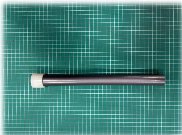
3. Вставьте расширительный инструмент до упора, при этом калибр головки должен быть подобран в соответствии с используемой трубой, затем необходимо расширить трубу с гильзой. Перед каждым расширением необходимо проворачивать трубу на 120 градусов.
