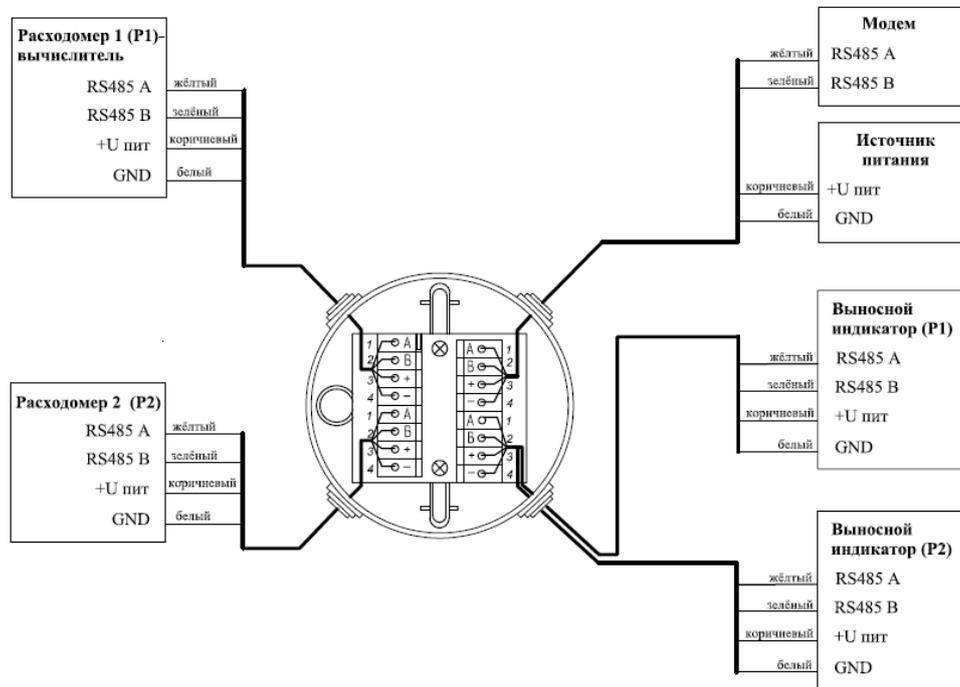
Схема подключения выносных индикаторов для теплосчетчиков с тремя расходомерами и двумя коммутационными коробками
