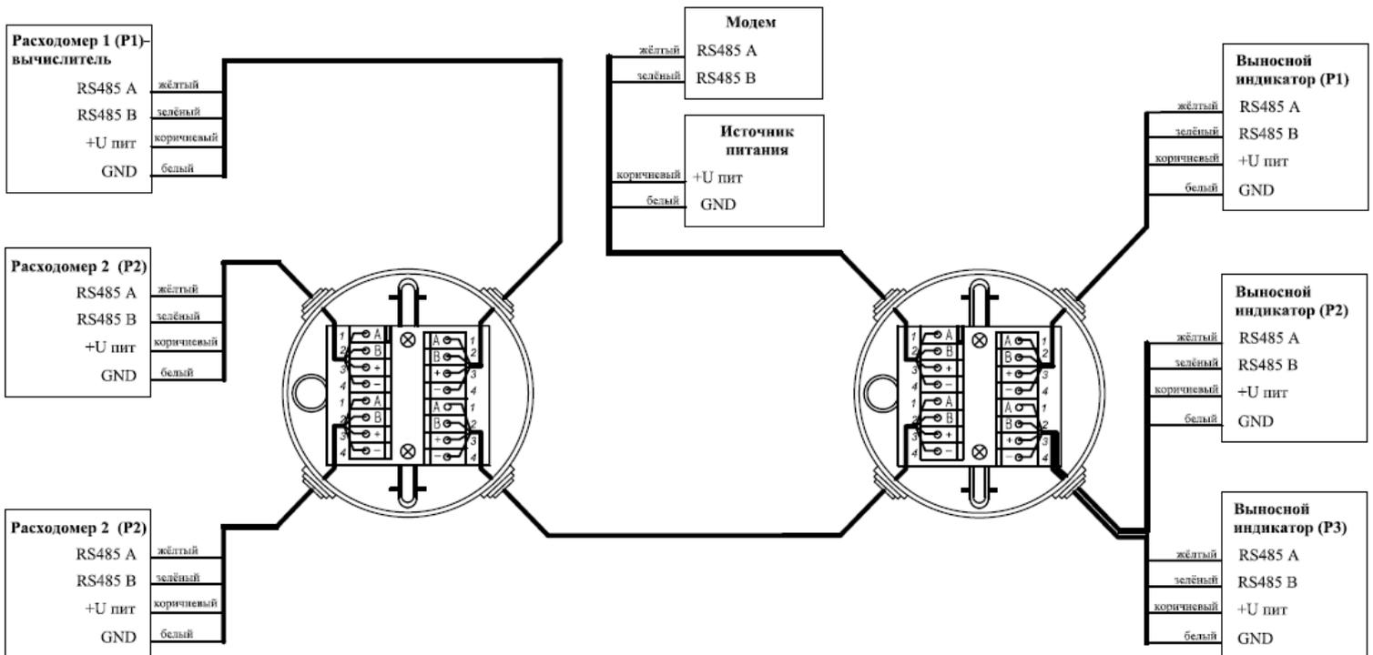
Количество подключаемых выносных индикаторов и расходомеров определяется комплектностью заказа
