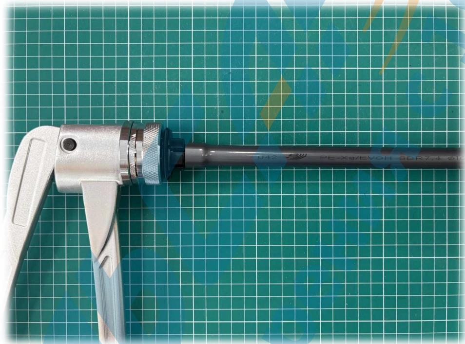
4. Вставьте штуцер фитинга в расширенный конец трубы до упора. Подождите немного, чтобы труба плотно охватила штуцер фитинга. Если фитинг не вставляется достаточно глубоко, извлеките его и выполните несколько дополнительных расширений, затем снова попробуйте вставить фитинг.
