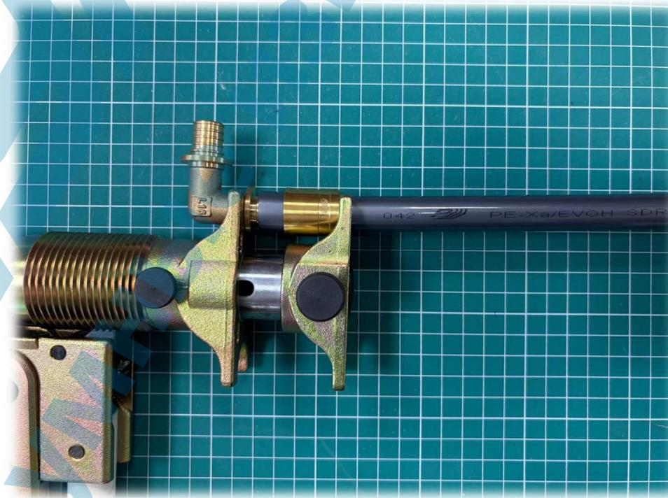
5. Визуально проверьте готовое соединение на наличие дефектов. Максимальный зазор не должен превышать 1,5 мм для всех диаметров.
