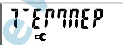
Рисунок 41 – Отображение пункта меню «Подстановочный параметр – температура газа»
