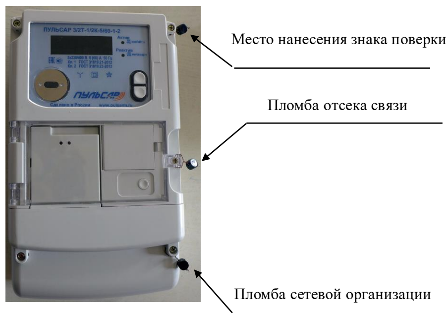
Рисунок 4 - Общий вид счётчиков с отсеком под модуль связи с указанием мест нанесения знака поверки, с указанием места пломбирования пломбой сетевой организации, а также с местом пломбирования отсека связи.
