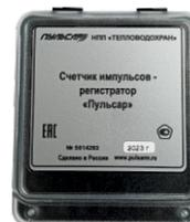
Счетчик импульсов – регистратор 3-канальный
